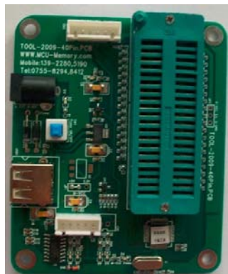
固件版本号为V3.6的脱机下载板(正面)
