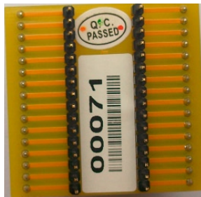
SOP-32的转换座(反面)
