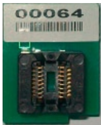
SOP-16和SOP-8的转换座(正面)
