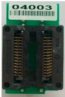
SOP-28和SOP-20的转换座(正面)
