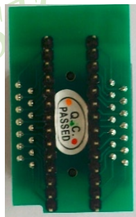
SOP-28和SOP-20的转换座(反面)
