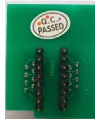
SOP-16和SOP-8的转换座(反面)
