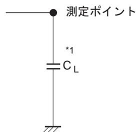
【注】 1. C<sub>L</sub> はプローブ, 治具などの浮遊容量を含みます。
