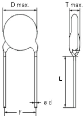
D:  $5.0 \pm 0.5\text{mm}$     F:  $5.0 \pm 0.5\text{mm}$     d:  $0.50 \pm 0.06\text{mm}$     L:  $20 \pm 0.5\text{mm}$     T:  $\leq 4\text{mm}$
