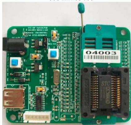
SOP-28转换座的安装
