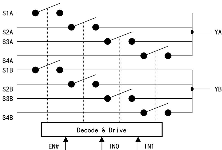
CH441 是 4 通道低阻宽带双向模拟开关芯片，引脚兼容 74HC4066、4016、74LV4066 芯片。CH441
