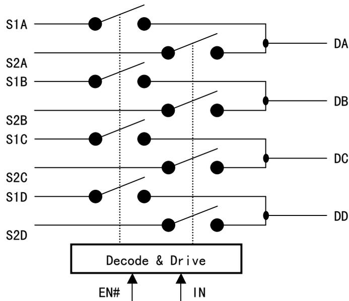
CH444 是双通道低阻宽带双向模拟开关芯片。CH444 包含 2 通道单刀四掷模拟开关，高带宽，低导通电阻，可以用于视频或者 USB 信号四选一切换。
