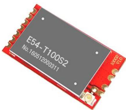
E54-T100S2 是一款 780M 贴片型无线串口模块 (UART)，半双工，收发一体，透明传输方式，发射功率 100mW，工作在 775.1~787.9MHz 免费频段 (默认 780.1MHz)，TTL 电平输出，兼容 3.3V 与 5V 的 IO 口电压，具有空中唤醒功能 (超低功耗)。
