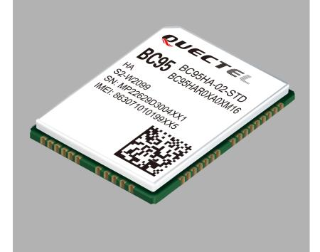
BC95 是一款高性能、低功耗的 NB-IoT 无线通信模块。其尺寸 仅为 19.9 × 23.6 × 2.2mm, 能最大限度地满足终端设备对小尺 寸模块产品的需求,同时有效地帮助客户减小产品尺寸并优化 产品成本。BC95 在设计上兼容移远通信 GSM/GPRS 系列的 M95 模块,方便客户快速、灵活的进行产品设计和升级。
