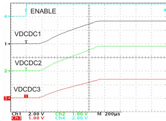
Figure 18. Startup VDCDC1, VDCDC2, VDCDC3
