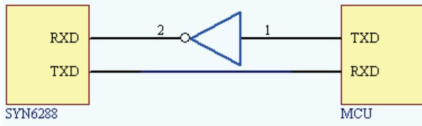
备注: 上位机发送数据给 SYN6288 时，中间须加有反向器，并须遵循《串口通信反向电路》一节中的说明。
