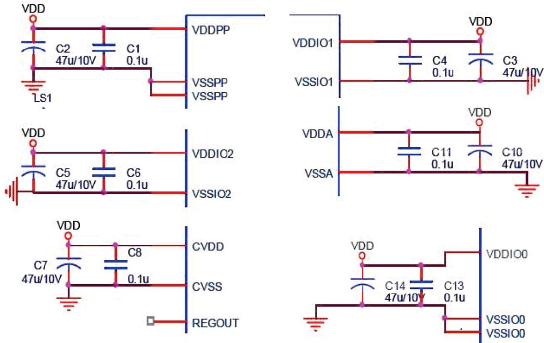
备注1: SYN 6288共有6组外接电源, 每组电源均使用一个47uF和一个0.1uF的电容; 如果用户想节省成本, 用户可以在每组电源上均使用0.1uF的电容, 并对VDDPP、和VDDA两组电源, 各加上一47uF的电容。
