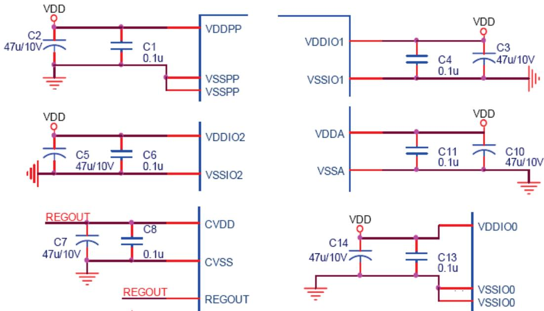
**备注1:** SYN 6288共有6组外接电源，每组电源均使用一个47uF和一个0.1uF的电容；如果用户想节省成本，用户可以在每组电源上均使用0.1uF的电容，并对VDDPP、和VDDA两组电源，各加上一47uF的电容。
