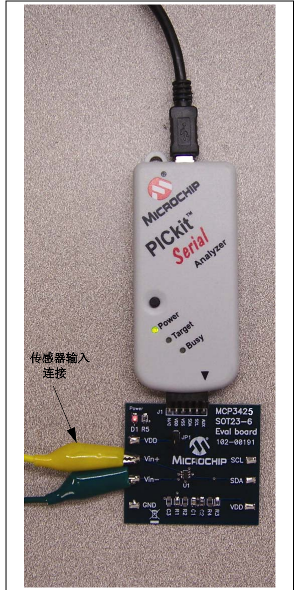
图 7-2: MCP3425 评估板和 PICkit™ 串行分析器配合使用的设置
