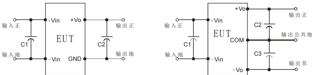
纹波&噪声测试: (双绞线法 20MHZ 带宽)
