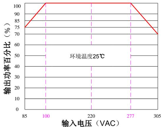
注 1：输入电压为 85~100VAC/277~305VAC/120~140VDC/390~430VDC，需在输入电压降额曲线图的基础上进行电压降额使用。
