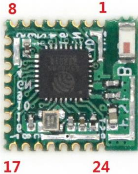
图 3 模块引脚正面排列图
