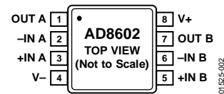
图2. 8引脚MSOP(RM后缀)和8引脚SOIC(R后缀)
