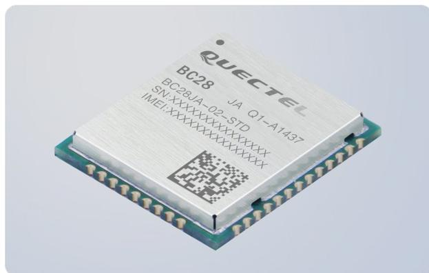
BC28 是一款超紧凑、高性能、低功耗的多频段 NB-IoT 无线通信模块，支持 B1/B3/B8/B5/B20/B28\*频段。其尺寸仅为 17.7mm × 15.8mm × 2.0mm，能最大限度地满足终端设备对小尺寸模块产品的需求，同时有效地帮助客户减小产品尺寸并优化产品成本。BC28 在设计上兼容移远通信 GSM/GPRS 系列的 M26 模块，方便客户快速、灵活的进行产品设计和升级。
