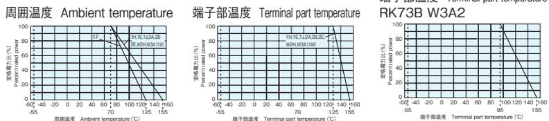
周囲温度70℃以上で使用される場合は、上図に示す負荷軽減曲線に従って、定格電力を軽減して御使用ください。
