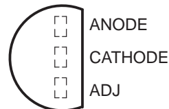
LM336-2.5, LM336B-2.5 . . . LP PACKAGE (TOP VIEW)
