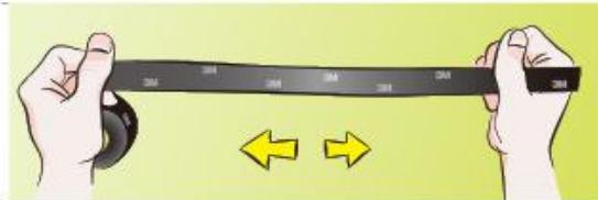
劣质胶带带基品质脆弱，两手拉伸带基表面出现断痕或裂纹，很容易断裂。
