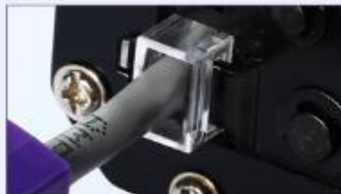
压接超五类水晶头
