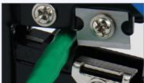
六类线缆剥线
