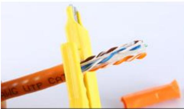
1 将线缆穿过水晶头护套，在线头2CM处用剥线刀将外皮剥去；
