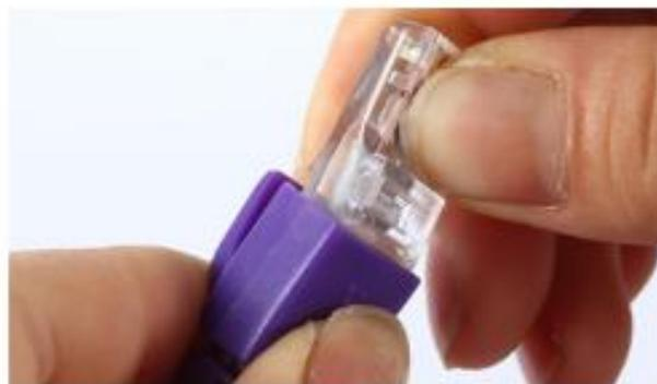
6 将压接好的水晶头按照图示方向插入护套
