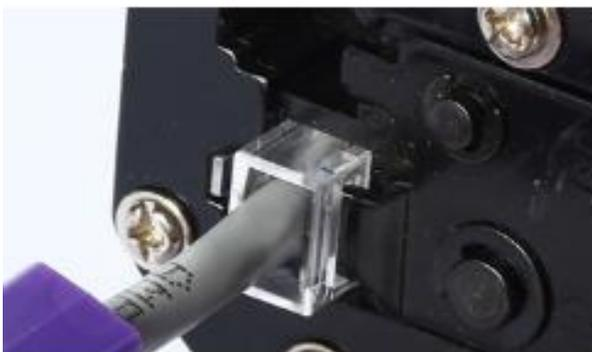
5 将水晶头放入压线钳 推至到位压接。
