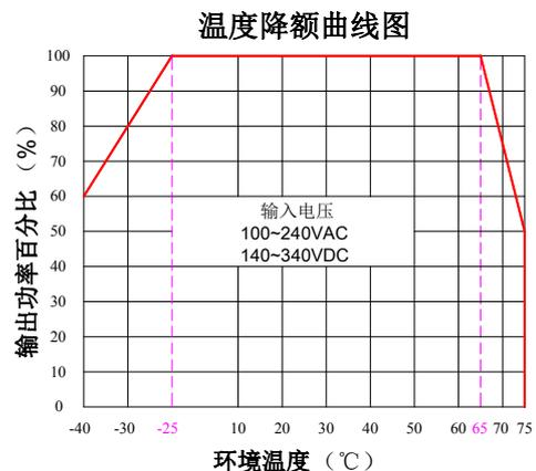
注 1：输入电压为 85~100VAC/240~265VAC/120~140VDC/340~380VDC，需在输入电压降额曲线图的基础上进行电压降额使用。
