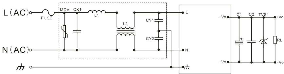
图 2: EMC 更高要求推荐电路
