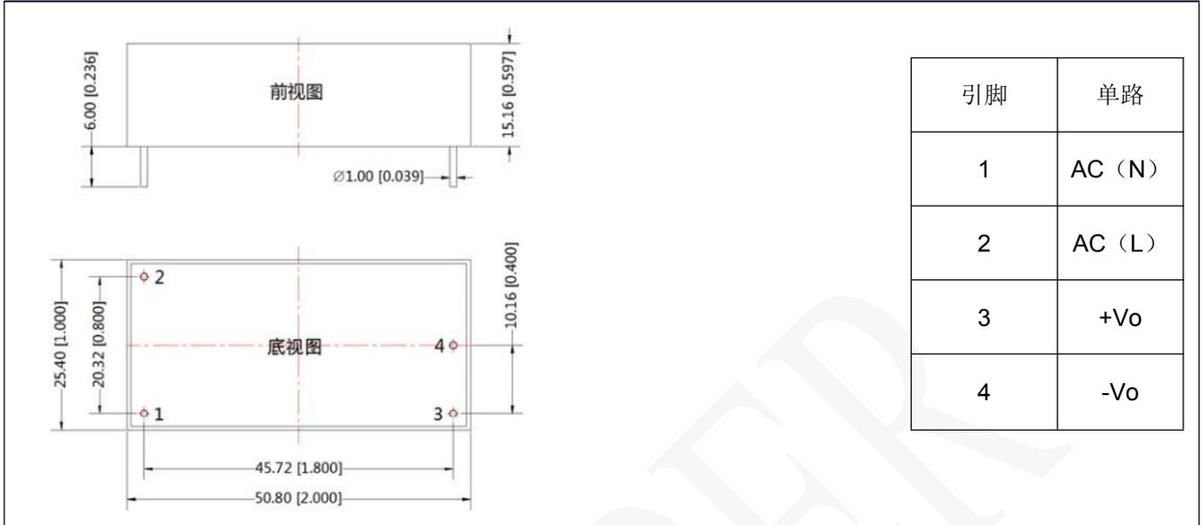
端子长度:  $\geq 3.50\text{mm}$ ;
