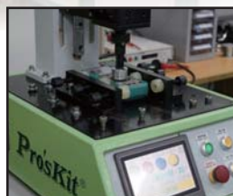
转盘/旋钮切换疲劳测试
