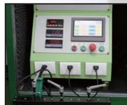
交流电气耐受与加速老化寿命测试
