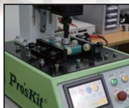
转盘/旋钮切换疲劳测试
