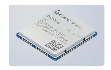
BC35-G 是一款高性能、低功耗的多频段 NB-IoT 无线通信模块,支持 B1/B3/B8/B5/B20/B28\*频段。其尺寸仅为 23.6mm × 19.9mm × 2.2mm,能最大限度地满足终端设备对小尺寸模块产品的需求,同时有效地帮助客户减小产品尺寸并优化产品成本。BC35-G 在设计上兼容移远通信 GSM/GPRS 系列的 M35 模块,方便客户快速、灵活的进行产品设计和升级。
