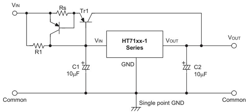
用于增加输出电压的电路
