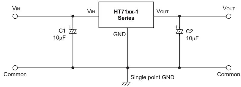
大电流输出正电压调节器
