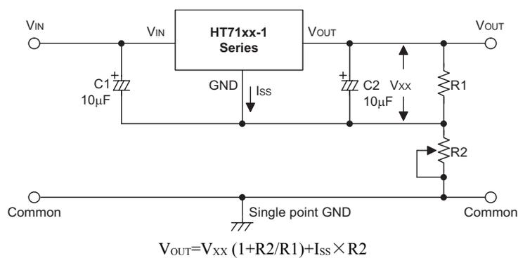
用于增加输出电压的电路
