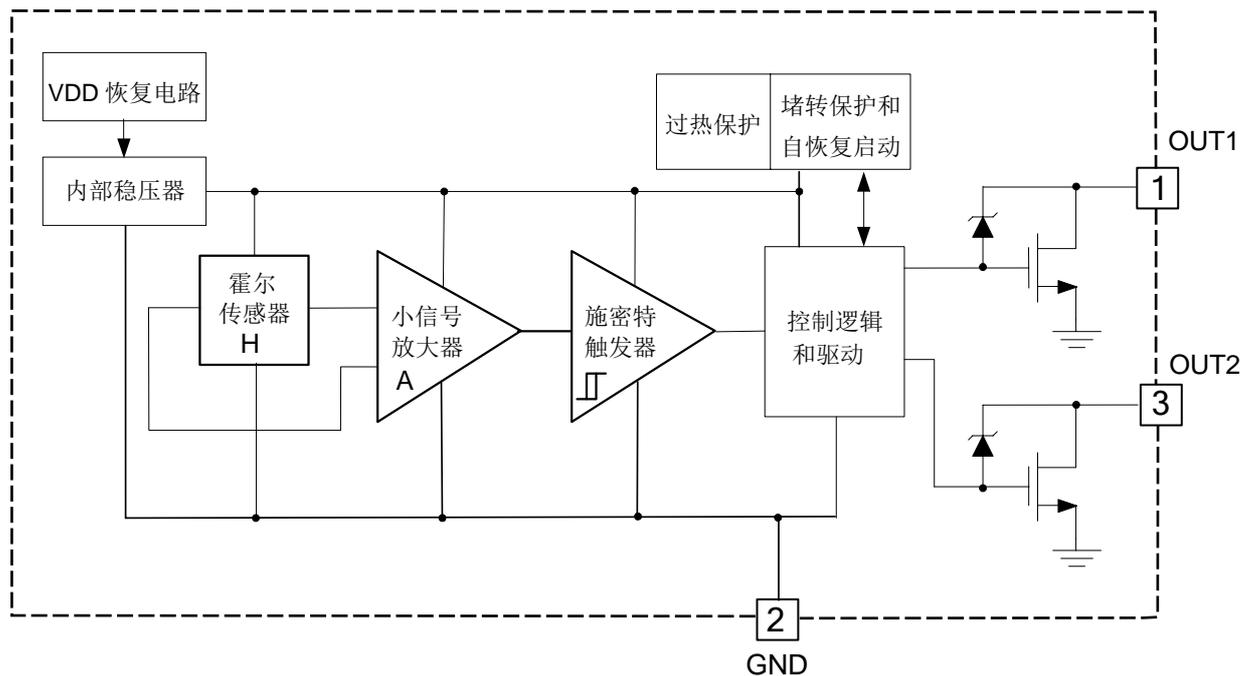
图 1, GH1279U 内部结构框示意图
