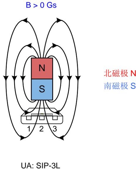
图 2, 磁场感应方向的定义
