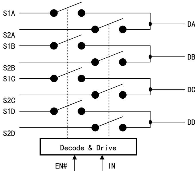
CH442E 是双通道低阻宽带双向模拟开关芯片。CH442E 包含 2 通道 SPDT 单刀双掷模拟开关，高带宽，低导通电阻，可以用于视频或者 USB 信号二选一切换。
