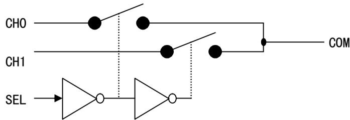
CH444G 和 CH444R 是双通道低阻宽带双向模拟开关芯片。CH444G 和 CH444R 包含 2 通道 SPST 单刀四掷模拟开关，高带宽，低导通电阻，可以用于视频或者 USB 信号四选一切换。
