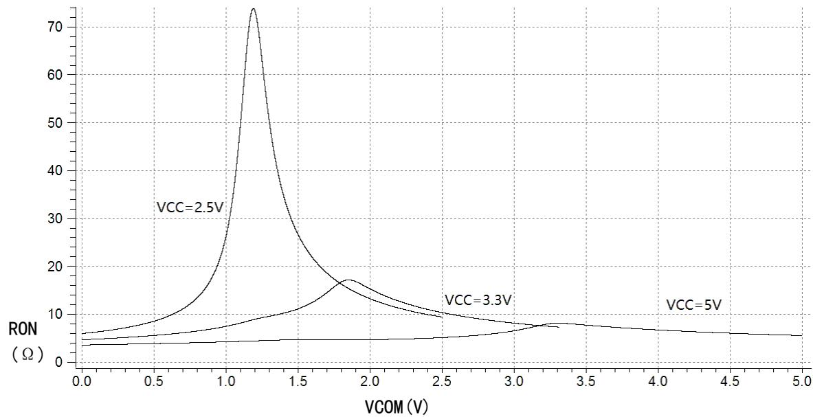
6.8.3 CH445 的模拟开关导通电阻  $R_{ON}$  与模拟信号电压  $V_{COM}$  的相关性 ( $TA=25^{\circ}\text{C}$ )
