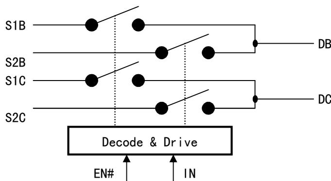
CH443K 是单通道低阻宽带双向模拟开关芯片。CH443K 包含 1 通道 SPDT 单刀双掷模拟开关，高
