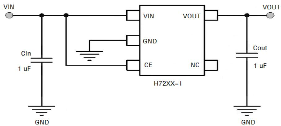
Note1:Input capacitor  $C_{IN}=1\mu F$ .
