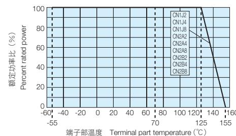
超过端子部温度使用时，请根据上图负荷减轻特性曲线减小额定功率后使用。
