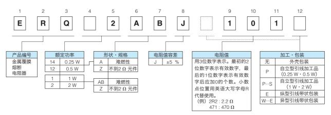
上述例子所示的是额定功率为 2 W 的金属覆膜熔断电阻器,是电阻值为 100  $\Omega$  电阻值容差为  $\pm 5$  % 的产品。
