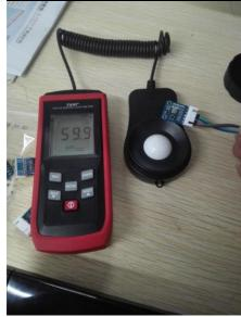
左图为传感器测出的通过串口打印的光照强度数值; 右图为特安斯 TA8133 手持式数字照度计测出的同一光源出的光照强度。
