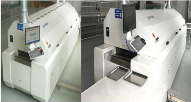
工厂车间图：SPD、TMOV回焊炉站
