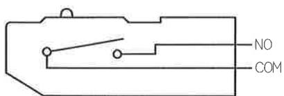
回路構成： 1回路 1接点 (COM-NO)
