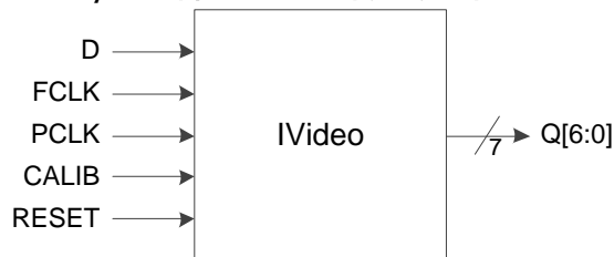
图 3-17 I/O 逻辑的 IVideo 输入示意图
