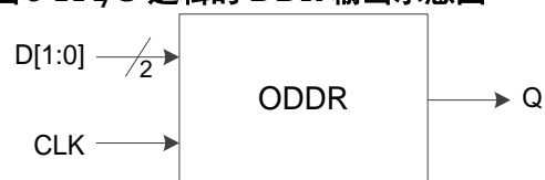
图 3-14 I/O 逻辑的 DDR 输出示意图
