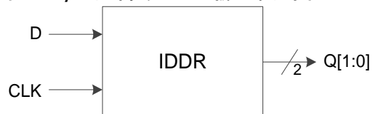
图 3-13 I/O 逻辑的 DDR 输入示意图
