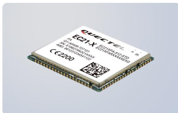
EC21 是移远通信专为 M2M 和 IoT 领域而设计的 LTE Cat 1 无线通信模块。它能很好的满足客户对高性价比的、低功耗的应用需求，并支持最大下行速率 10Mbps 和最大上行速率 5Mbps。EC21 系列尤其适用于对网络速率要求不高、但要求稳定可靠的 LTE 网络连接の場合。
