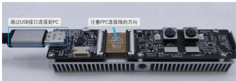
图 2.2 连接 VisionSeed 到电脑 USB 接口
