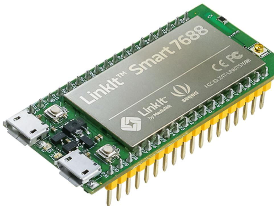
LinkIt Smart 7688 (一个紧凑型控制器板) 是基于 MT7688 (芯片)，它运行 Linux 的 Open Wrt 系统。该主板专为用于智能家居的 Rich Application IoT devices 的原型而设计。该板提供足够的内存，能实现强大的视频处理功能。该平台还提供了能在 Python, Node.js 和 C 编程语言中创建设备应用程序的选项。该板只是 MediaTek LinkIt Smart 7688 平台的一部分，这个平台还包括其他开发板。
