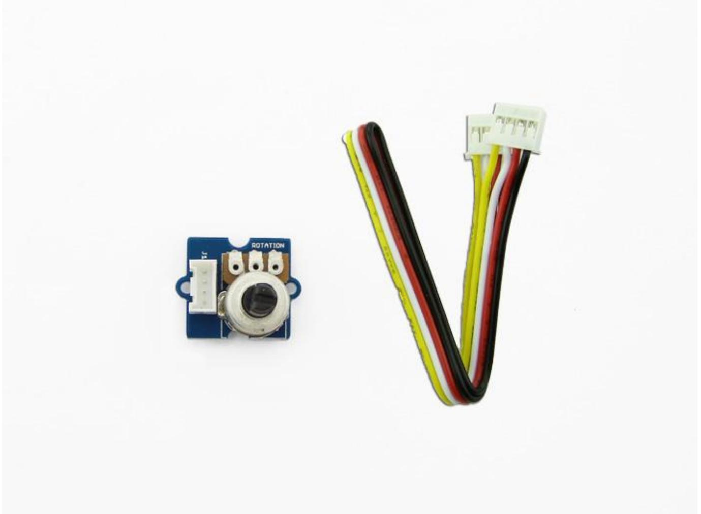
电位计在其 D1 连接器上产生 0 和 Vcc 之间的模拟输出 (5V 直流, 使用 Seeeduino)。D2 连接器未使用。角度范围为 300 度, 具有线性变化的特性。电阻值为 10 欧姆, 非常适合 Arduino 使用。这也可以称为旋转角度传感器。
