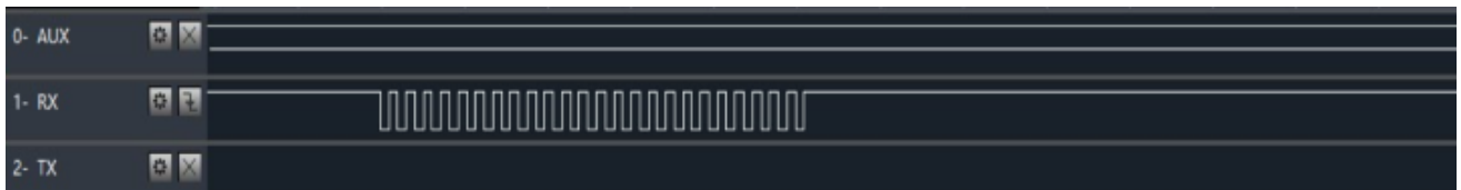
模块接收串口数据时，AUX引脚时序图（连传模式）
