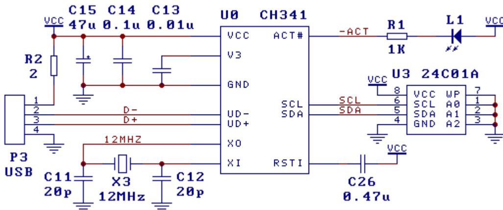
P3 是 USB 端口，USB 总线包括一对 5V 电源线和一对数据信号线，通常，+5V 电源线是红色，接地线是黑色，D+ 信号线是绿色，D- 信号线是白色。USB 总线提供的电源电流通常可以达到 500mA，一般情况下，CH341 芯片和低功耗的 USB 产品可以直接使用 USB 总线提供的 5V 电源。如果 USB 产品通过其它供电方式提供常备电源，那么 CH341 也应该使用该常备电源，如果需要同时使用 USB 总线的电源，那么可以通过阻值约为 1Ω 的电阻连接 USB 总线的 5V 电源线与 USB 产品的 5V 常备电源，并且两者的接地线直接相连接。
