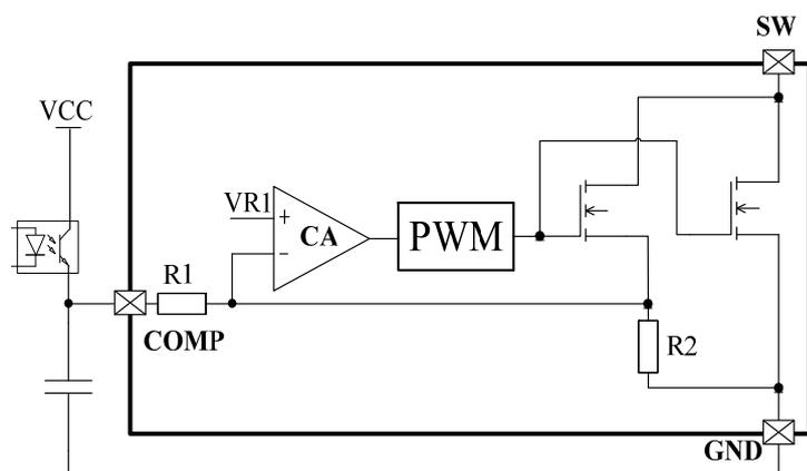
图 2 反馈电路
