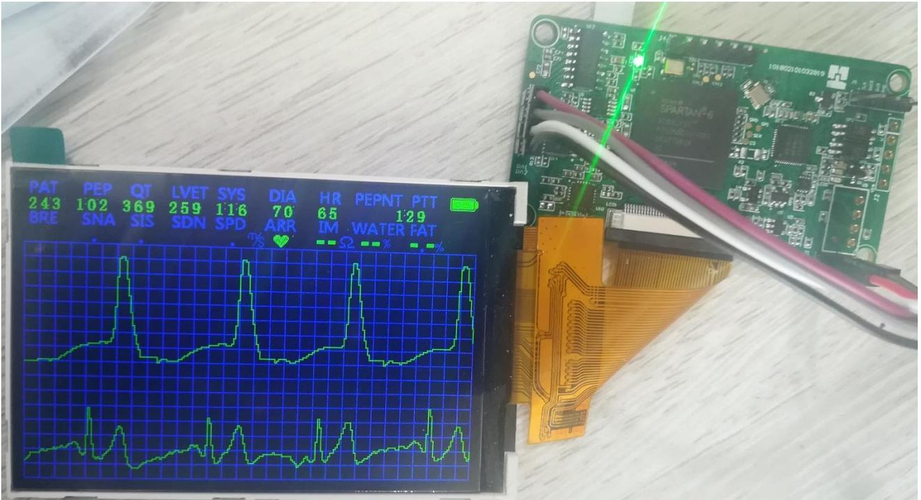
注：LCD1（默认不安装）可支持 40PIN 的真彩 TFT 屏幕，如需要液晶屏和显示功能需要联系厂家。
