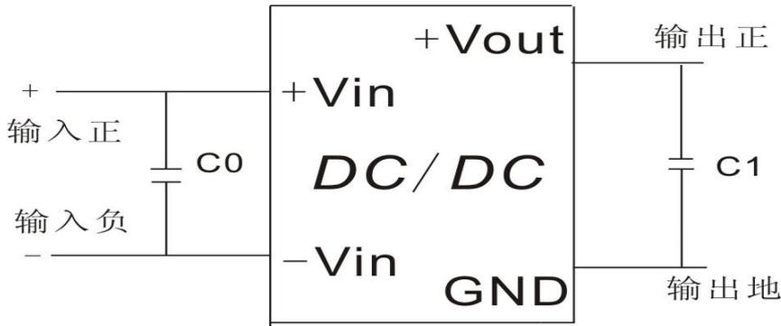
**2、输入反射纹波电流测试电路:**
