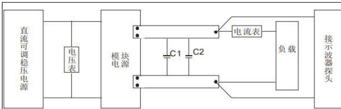
注：C1=1uF;C2=10uF;电容耐压值要高于模块输出电压。
