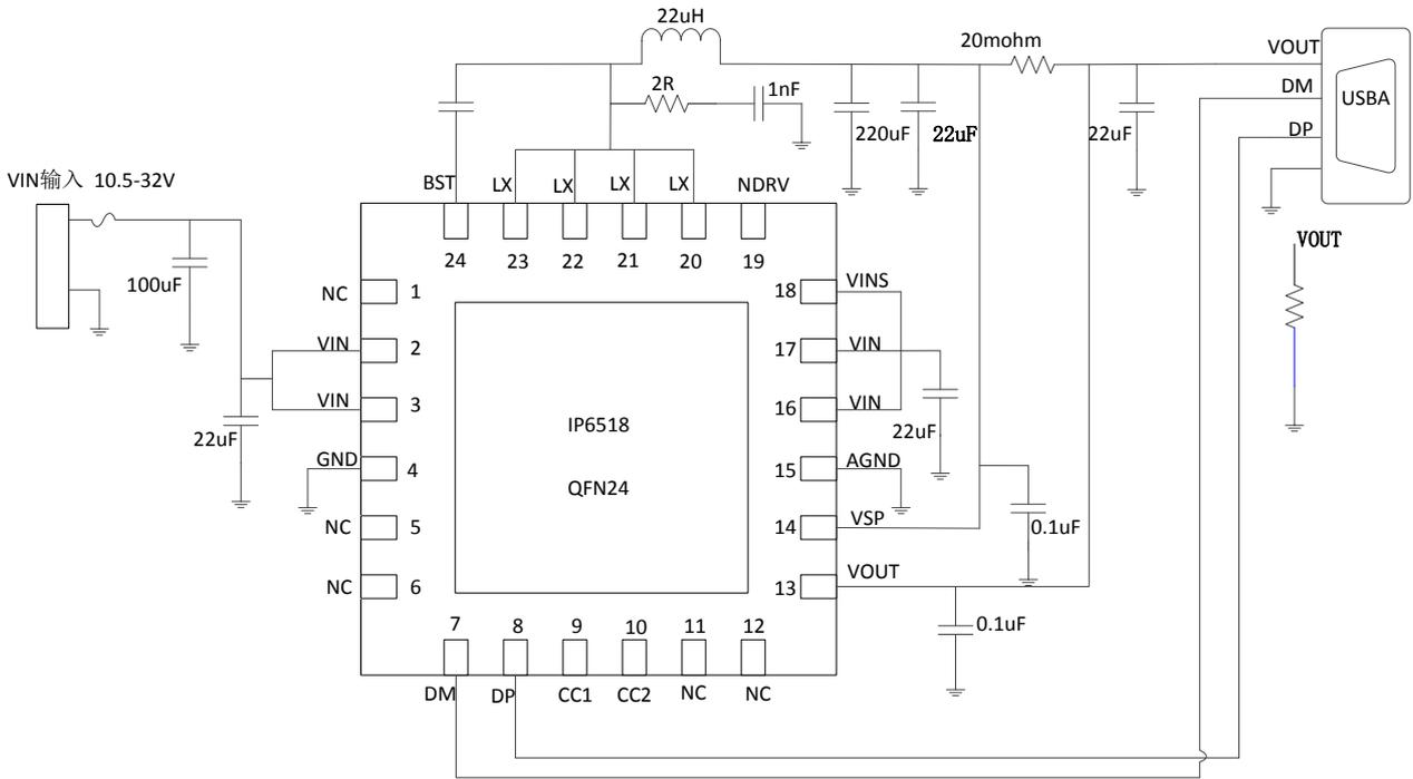
图 1 IP6518 简化应用原理图
