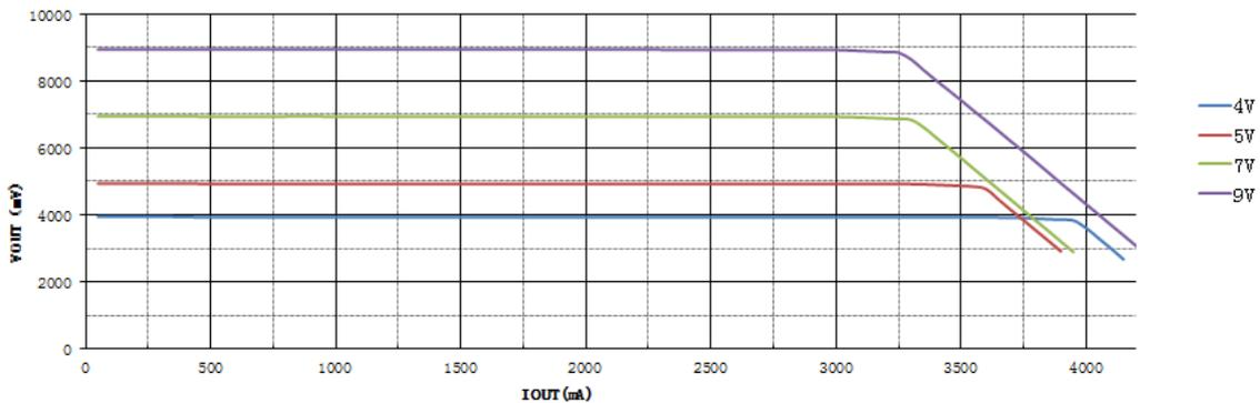
图 4 IP6518Vout-Iout 曲线
