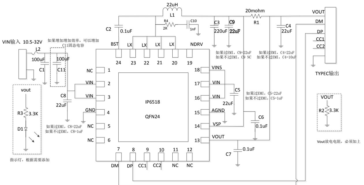
图 6 TYPEC 口 PD 快充输出应用原理图
