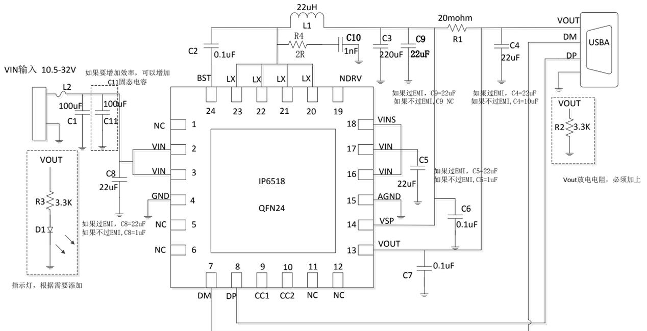
图 5 USB 口输出应用原理图
