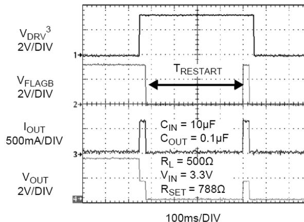
Figure 26.  $t_{RESTART}$  vs. Response<sup>(3)</sup>
