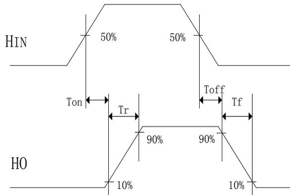
7-2. 高端输出 HO 开关时间波形图
