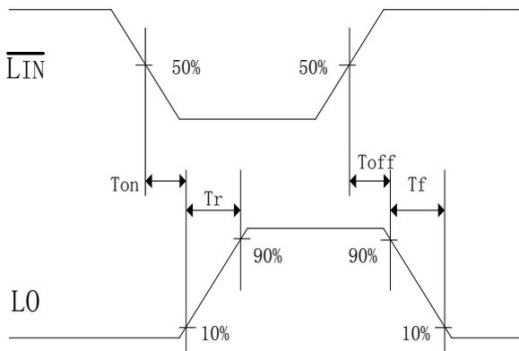
图 7-1. 低端输出 LO 开关时间波形图
