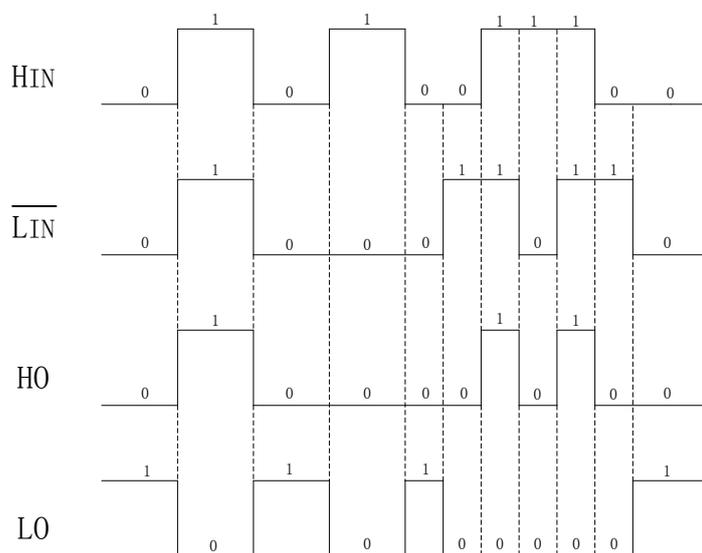
图8-2. 输入信号和输出信号逻辑功能图
