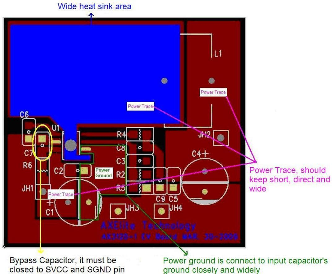
(AX3120 SOP-8L-EP PCB Layout -Top View)
